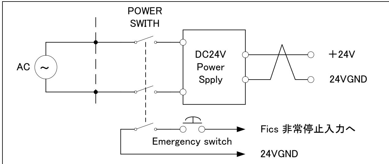
[2] [1]で改善されない場合は、電源オフディレータイマを追加して、DC24Vの電源断を0.1~0.2sec程度遅らせて下さい。
